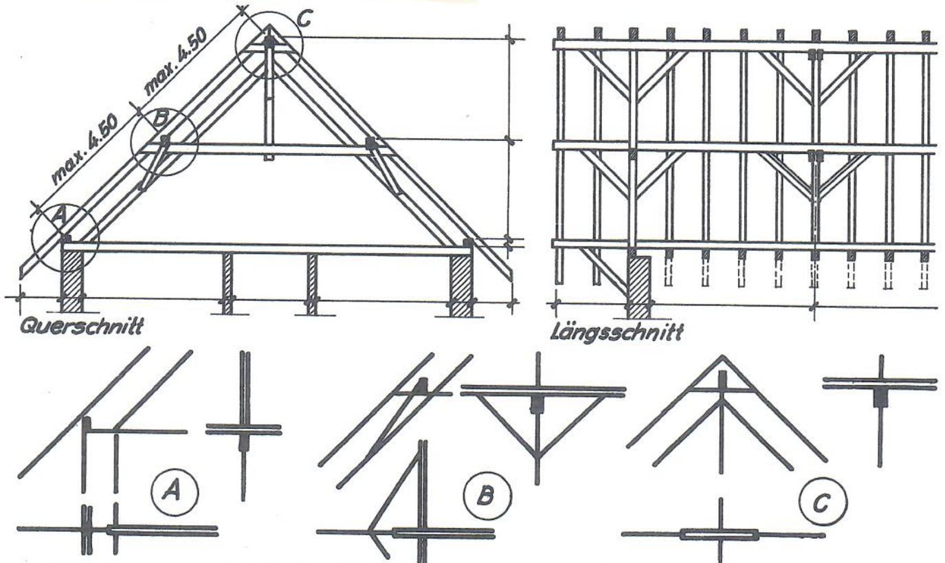
Aufgabe : Zeichne Querschnitt, Längsschnitt und Grundriss M. 1:50, Details M. 1:10.
