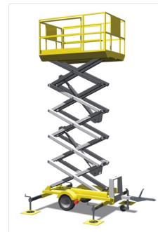
Statisch Vertikal (1a): Senkrecht-Hubarbeits- bühnen auf Stützen
