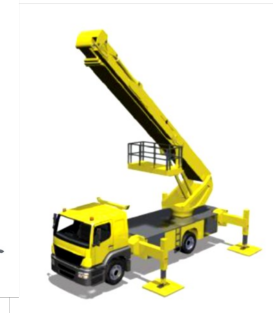
Statisch Boom (1b): Ausleger-Hubarbeits- bühnen auf Fahrzeugen
