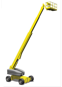
Mobil Boom (3b): Während des Einsatzes fahrbare Ausleger-Hubarbeits- bühnen
