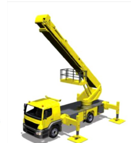
Statisch Boom (1b): Ausleger-Hubarbeits- bühnen auf Fahrzeugen
