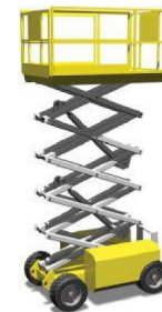
Mobil Vertikal (3a): Während des Einsatzes fahrbare Senkrecht-Hubarbeits- bühnen
